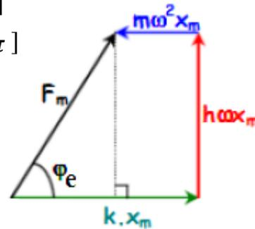
Construction de Fresnel dans le cas où :  $\omega_e < \omega_0$
