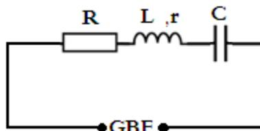
b- Par analogie, l'équation différentielle mettant en jeu la charge  $q$  du condensateur du circuit électrique est :  $L \frac{d^2q}{dt^2} + R_T \frac{dq}{dt} + \frac{1}{C}q = u(t)$
